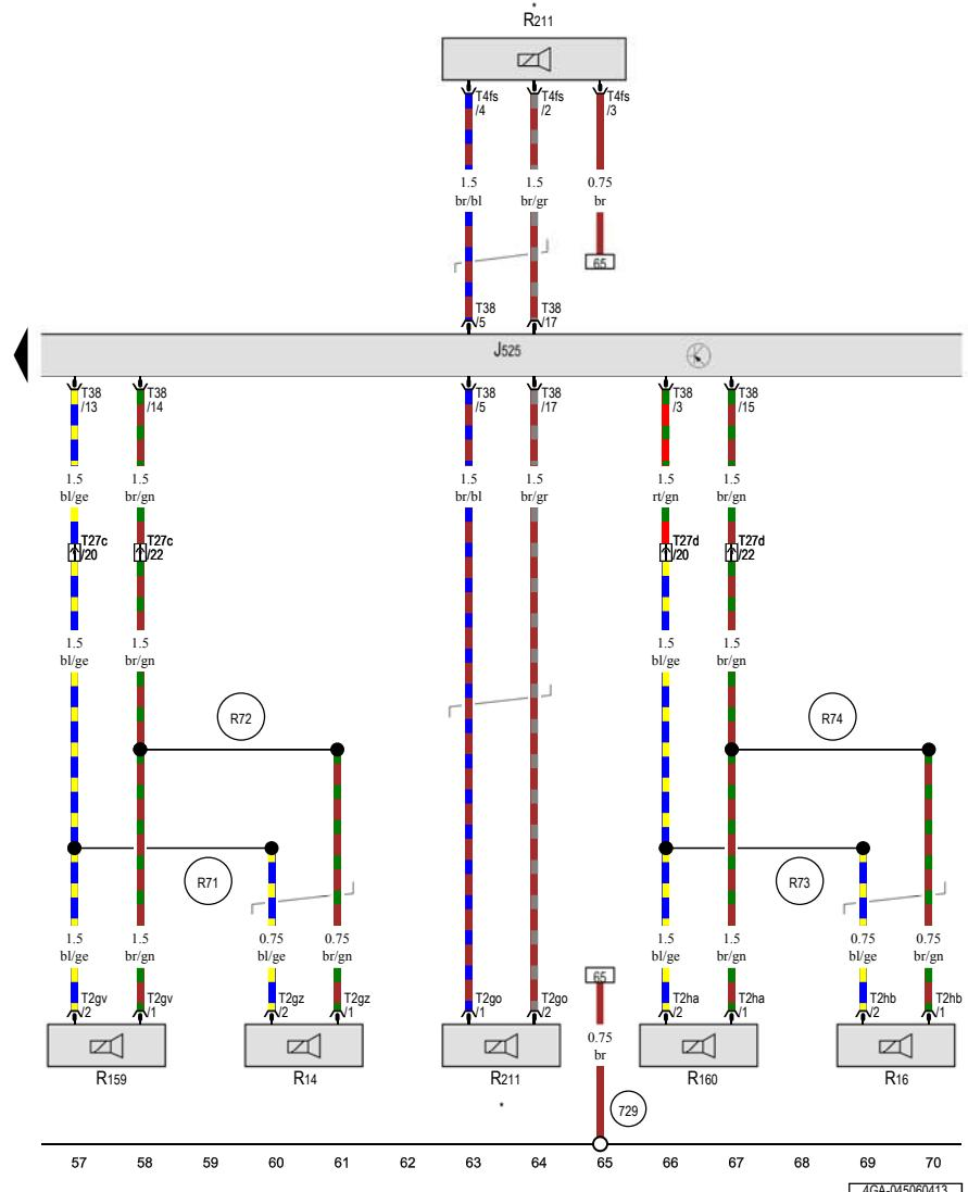
数字式声音处理系统控制单元, 左后高音喇叭, 右后中低音喇叭, 重低音
